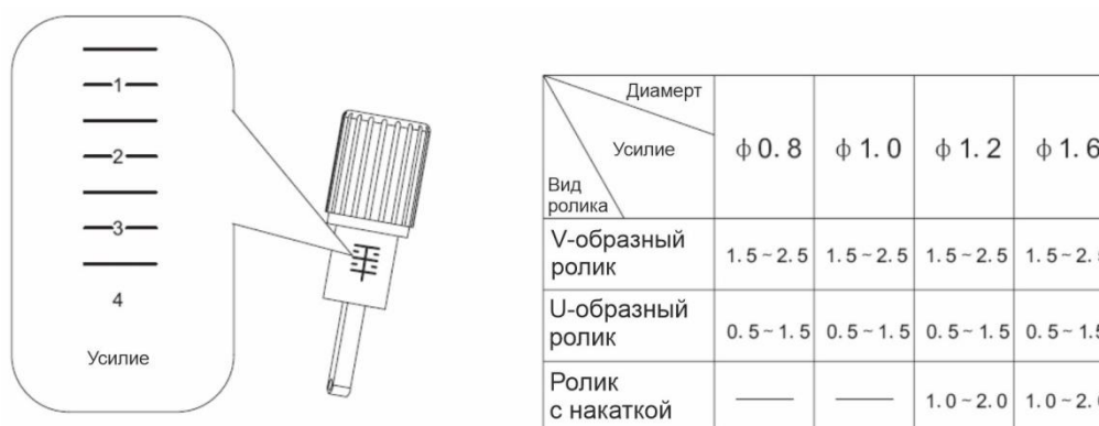
Рис. 24 Усилия зажатия подающих роликов
